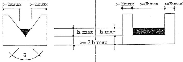
NB per portate superiori a 200 mc/ora è necessario installare un misuratore tipo Venturi, anziché uno stramazzo. Per l'installazione di tale misuratore è necessario consultare una ditta specializzata.
